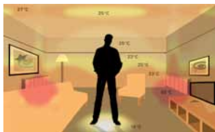
Rozkład temperatury przy zastosowaniu konwencjonalnego systemu ogrzewania z grzejnikami. Duże różnice temperatur w pomieszczeniu (18 - 65°C).
